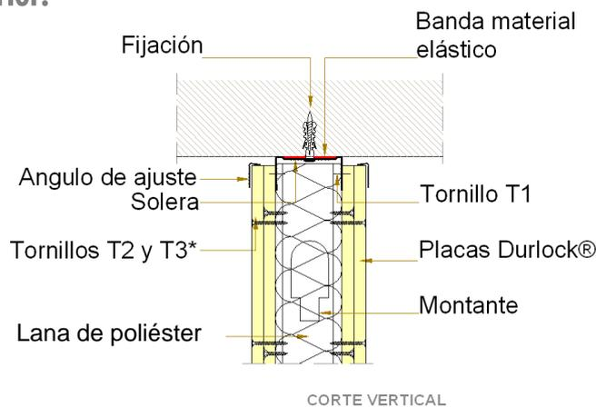
\* Los tornillos T2 se colocan a 50mm del borde de la placa., en caso de utilizar placas de 15mm de espesor, el Tornillo T3 se reemplazará por Tornillo T4.
