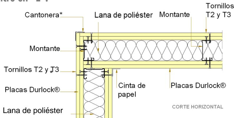
•El perfil Cantonera podrá fijarse con tornillos T2 colocados con una separación de 15cm o con adhesivo de contacto. Luego recibirá dos manos de masilla Durlock®.
