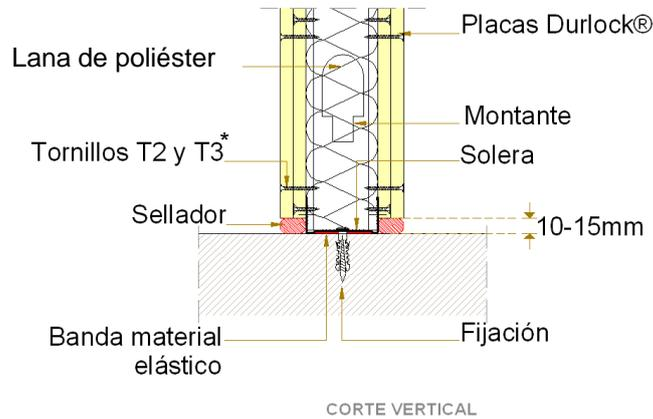
\* En caso de utilizar placas de 15mm de espesor, el Tornillo T3 se reemplazará por Tornillo T4.
