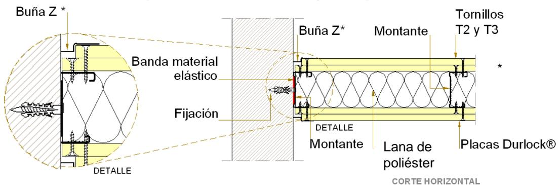
•El perfil Buña Z podrá fijarse con tornillos T2 colocados con una separación de 15cm o con adhesivo de contacto. Luego recibirá dos manos de masilla Durlock®.. En caso de utilizar placas de 15mm de espesor, el Tornillo T3 se reemplazará por Tornillo T4.
