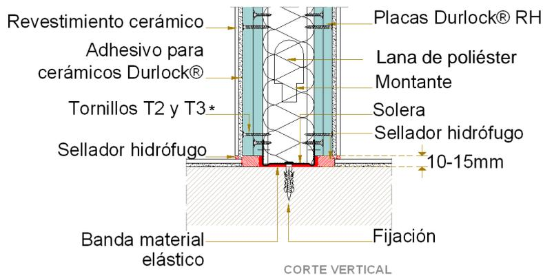
\* En caso de utilizar placas de 15mm de espesor, el Tornillo T3 se reemplazará por Tornillo T4.
