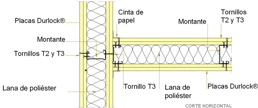
\* En caso de utilizar placas de 15mm de espesor, el Tornillo T3 se reemplazará por Tornillo T4.
