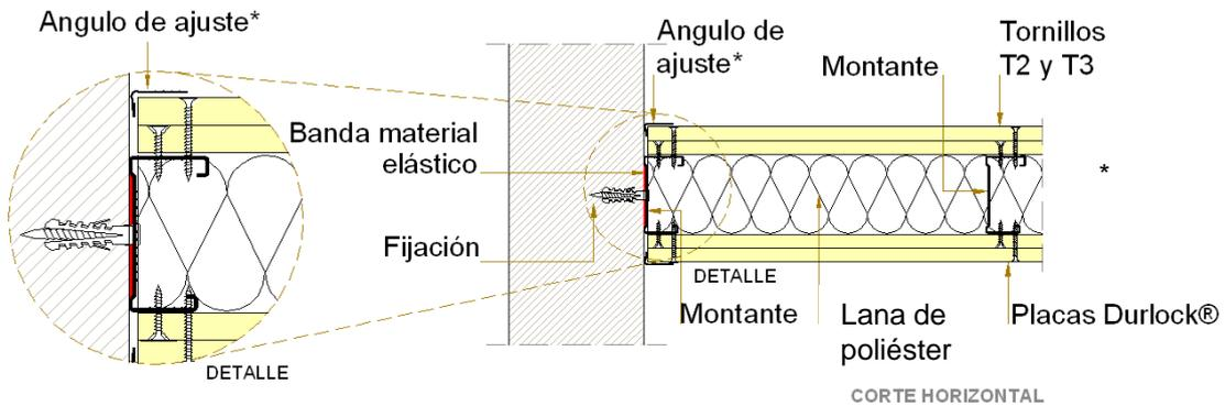
\*El perfil Angulo de ajuste podrá fijarse con tornillos T2 colocados con una separación de 15cm o con adhesivo de contacto. Luego recibirá dos manos de masilla Durlock®.
